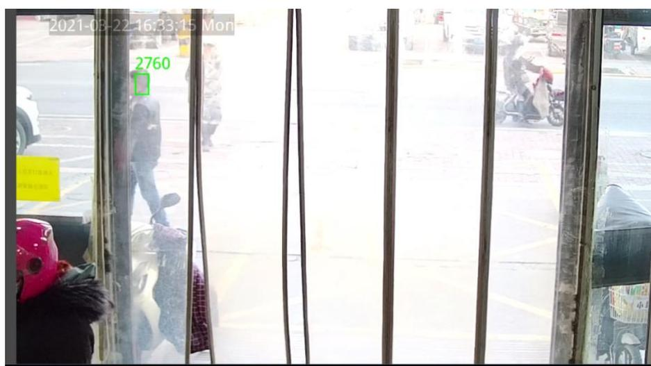
1 从图中可以看出抓拍机照射门口很容易出现逆光现象，对抓拍有一定难度，可以尝试调节抓拍的图像参数，如打开宽动态、适当降低曝光等，或者调整相机安装角度/位置，来确保抓拍人脸质量
