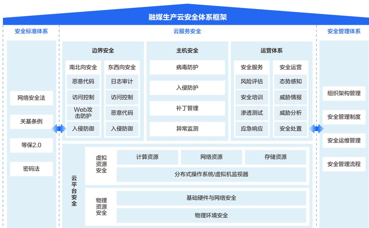
图 29. 云平台的安全架构
