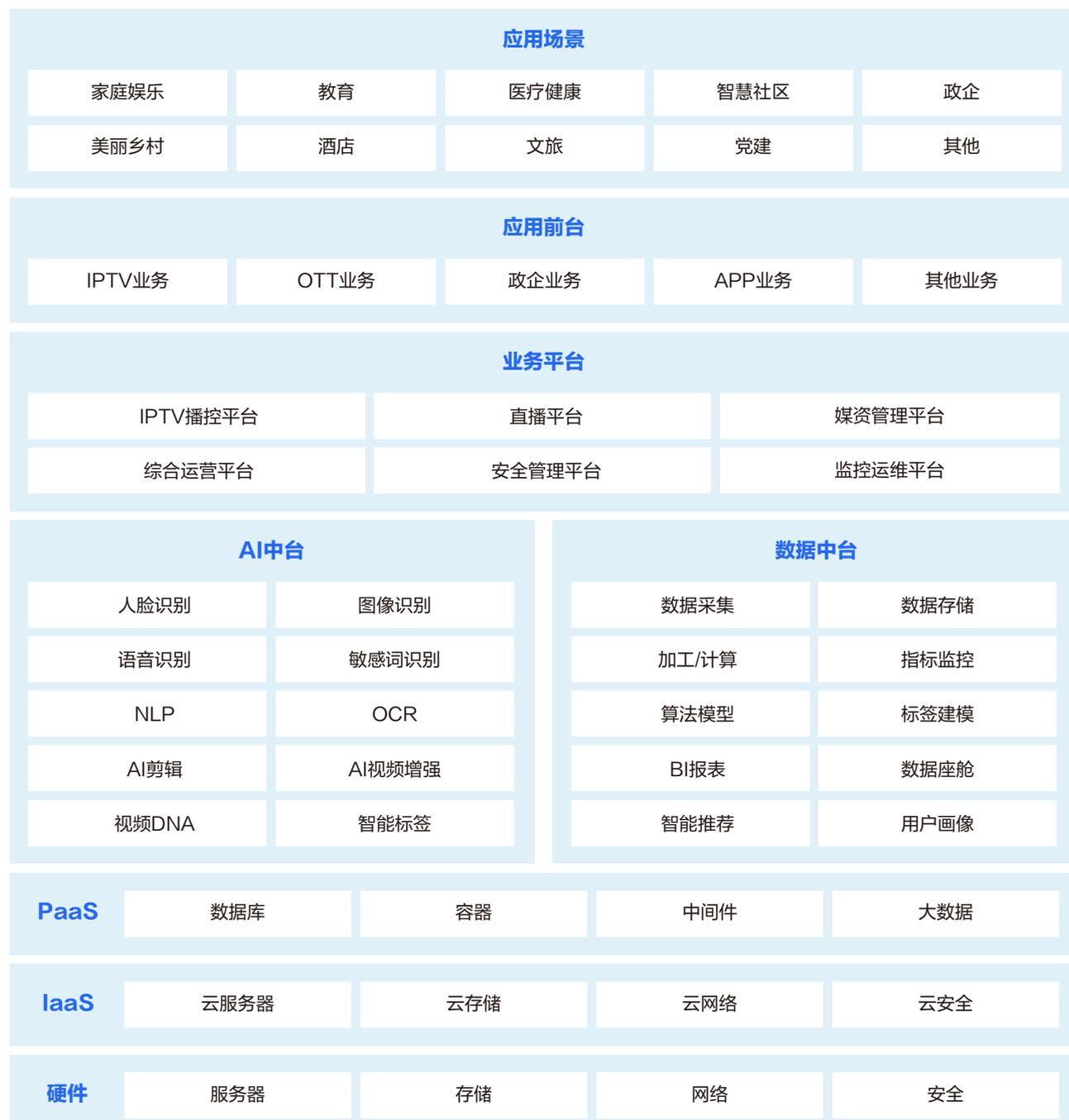
图 13. 云平台的目标架构
